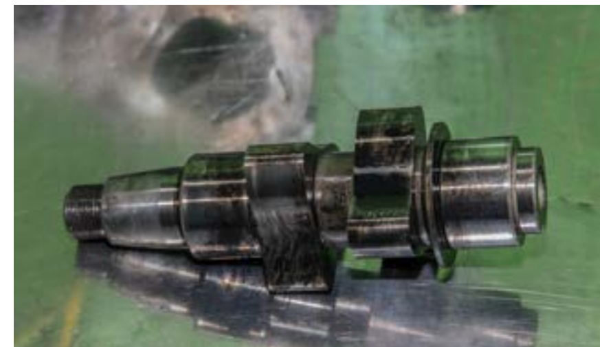
На поверхности приводного вала топливного насоса имеется характерный налет смолистых отложений. Так проявляется работа агрегата на сработавшем моторном масле
