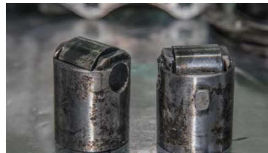
Прочно осевшие на поверхности стаканчиков роликовых толкателей смолистые отложения стали причиной заклинивания элементов в корпусе насоса
