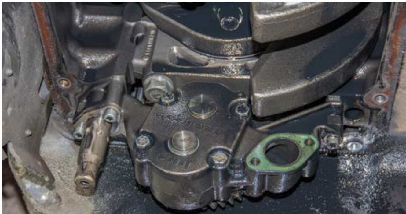
Масло с деградировавшей основой и пакетом присадок быстро выводит из строя масляный насос
