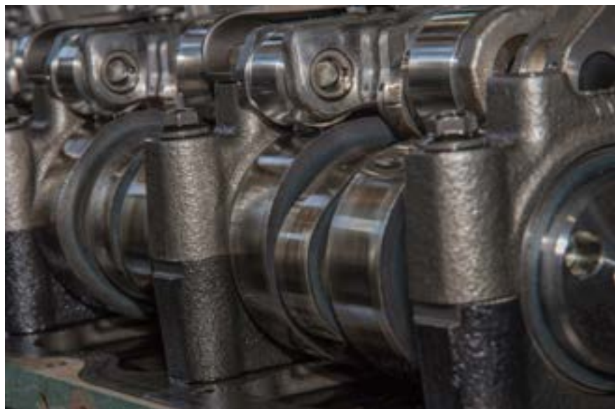
При деградации пакета присадок моторного масла происходит выкрашивание металла в паре ролик/кулачок вала
