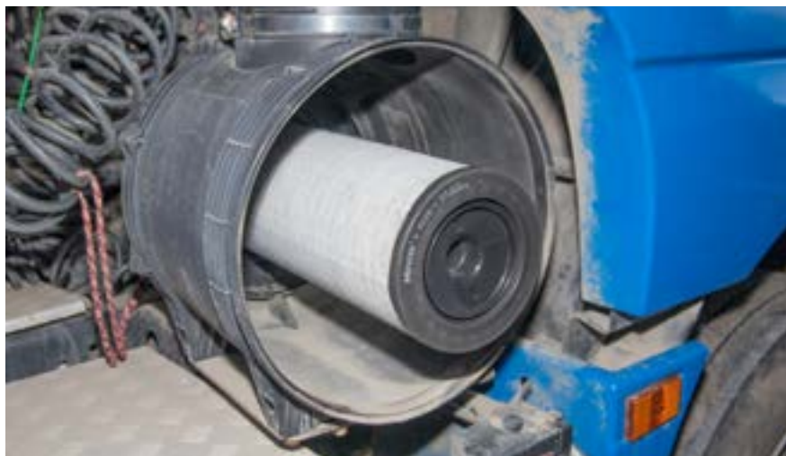
Система фильтрации с двумя элементами (основной и страховочный) дает наивысшие результаты по очистке воздуха, но только при условии, что характеристики фильтровальных штор обоих элементов соответствуют требованиям автопроизводителя
