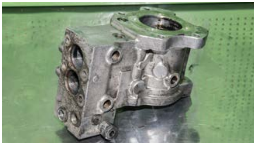
Если корпус насоса получил повреждения, то ремонт агрегата в большинстве случаев нерентабелен. Купить новый корпус невозможно
