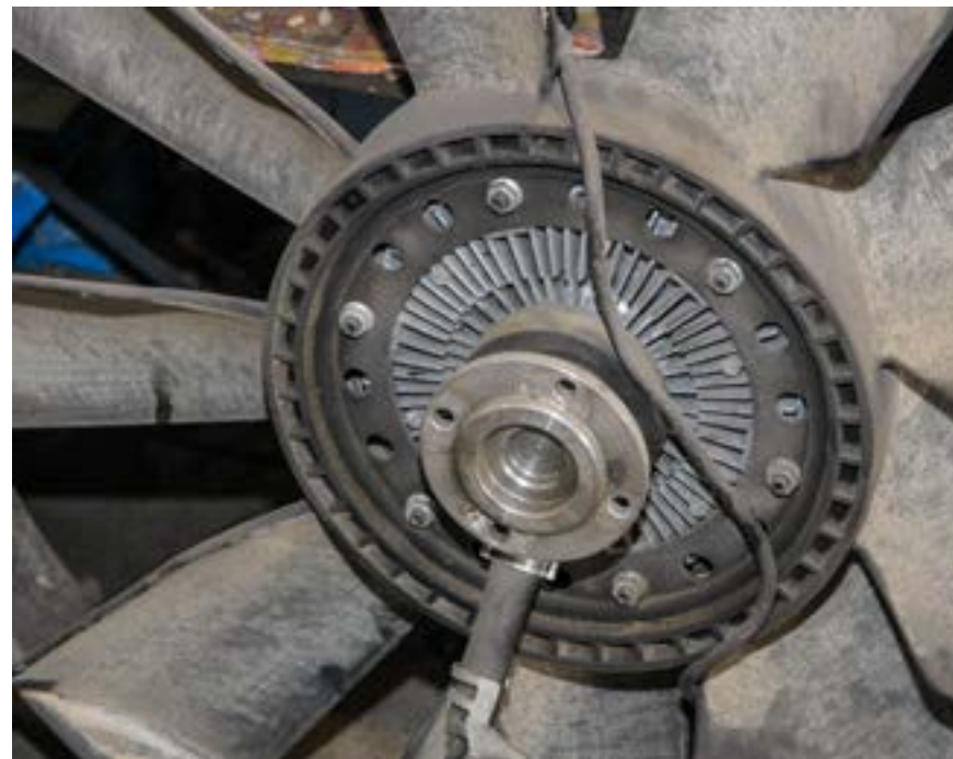
Из-за отказа вязкостной муфты происходит нарушение теплового режима мотора и быстрое срабатывание моторного масла
