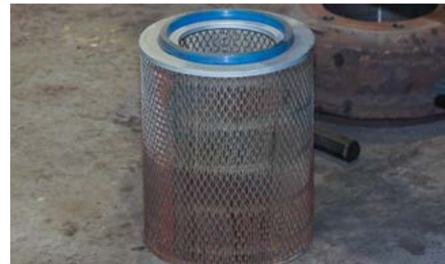
Металлическая сетка в нижней части фильтра сильно поражена коррозией. Машина выполняла перевозки в условиях повышенной влажности воздуха. У качественных фильтров обечайки, как правило, не корродируют
