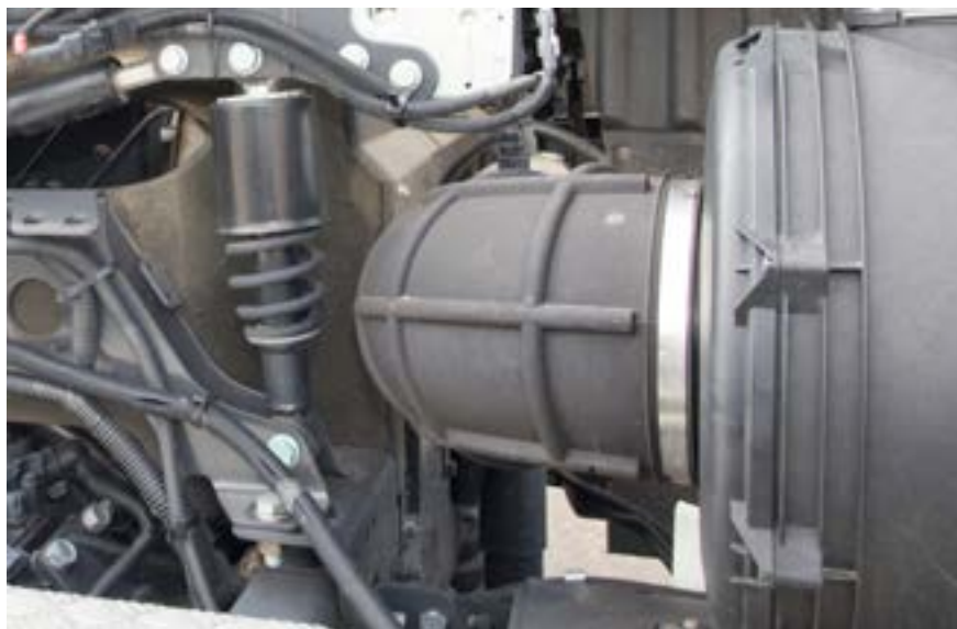
Максимум внимания при обслуживании машин необходимо уделять стыкам элементов впускного тракта. Через неплотности происходит подсос пыли
