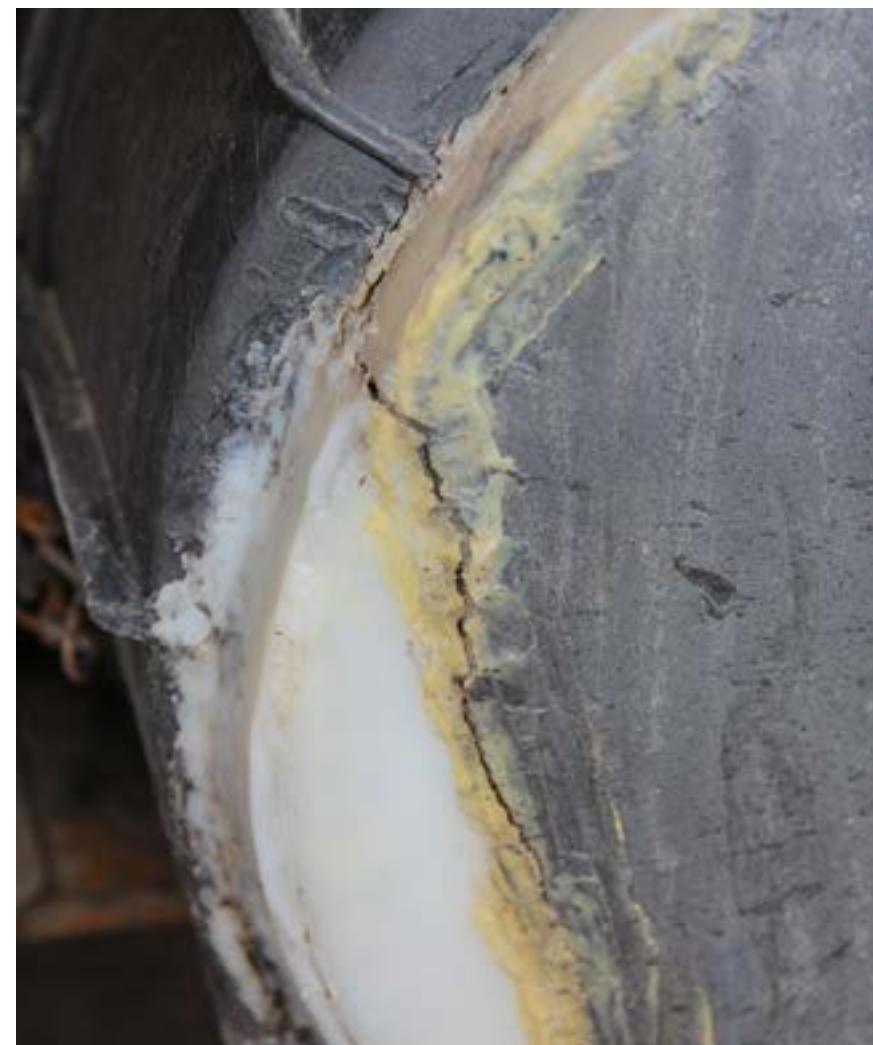
Трещина на корпусе воздушного фильтра открывает путь неочищенному воздуху во впускной тракт. Ремонт повреждения полимерными составами не всегда дает положительный результат
