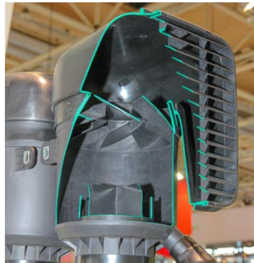
Устройство предварительной очистки воздуха от крупных частиц грязи, представляющее собой аппарат, меняющий направление воздушного потока, позволяет существенно снизить нагрузку на воздушный фильтр и продлить его ресурс
