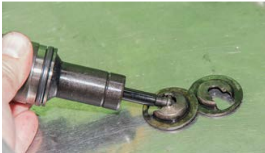
Тарелка механизма привода плунжера треснула из-за высокой нагрузки, вызванной заклиниванием штока
