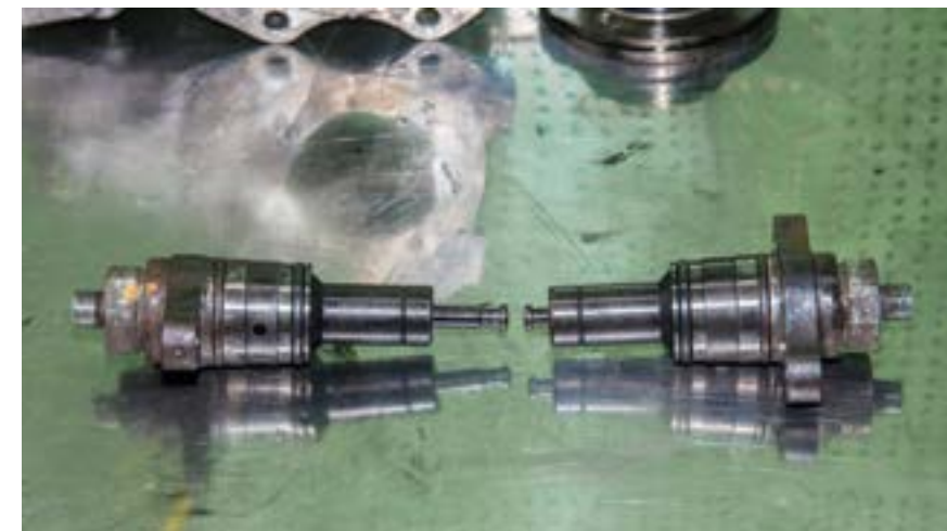
Из-за сработавшего моторного масла происходит ухудшение условий смазки насосных секций и заклинивание их штоков
