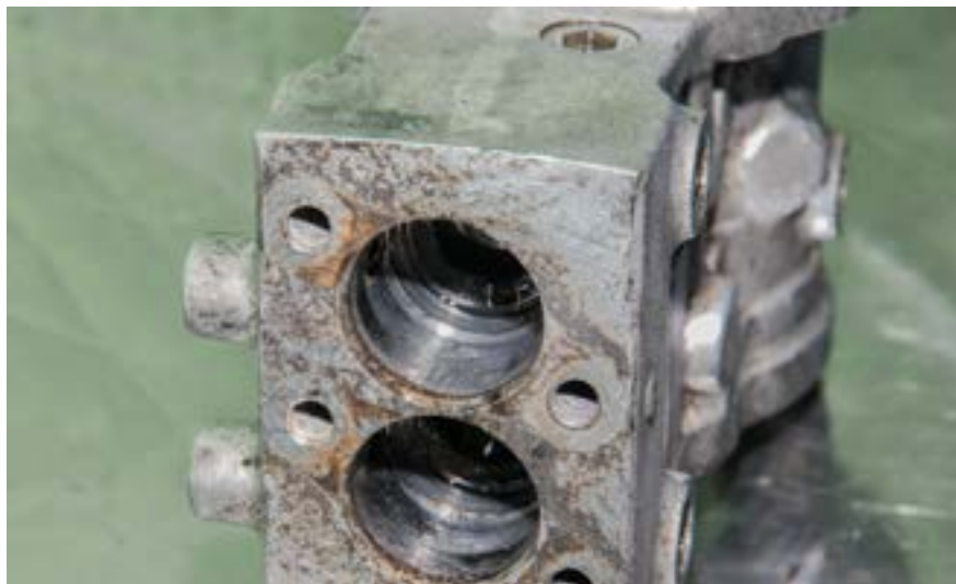
Следы заклинивания стаканчиков роликовых толкателей в корпусе насоса. Деталь – в утиль
