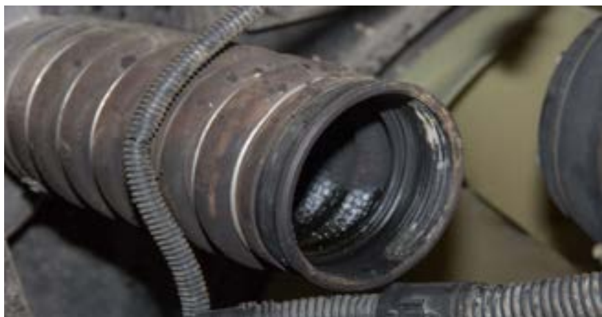
Соединительные манжеты впускного тракта со временем теряют эластичность и трескаются. На их состояние может оказывать негативное влияние моторное масло, которое забрасывает в тракт неисправный турбокомпрессор
