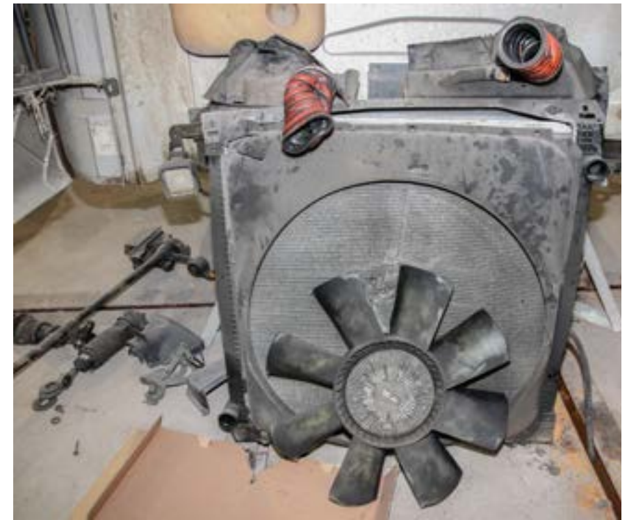
Чтобы мотор не перегревался, необходимо следить за чистотой радиаторов и их техническим состоянием. При потере герметичности радиатор лучше заменить новым, а не ремонтировать с непредсказуемым результатом
