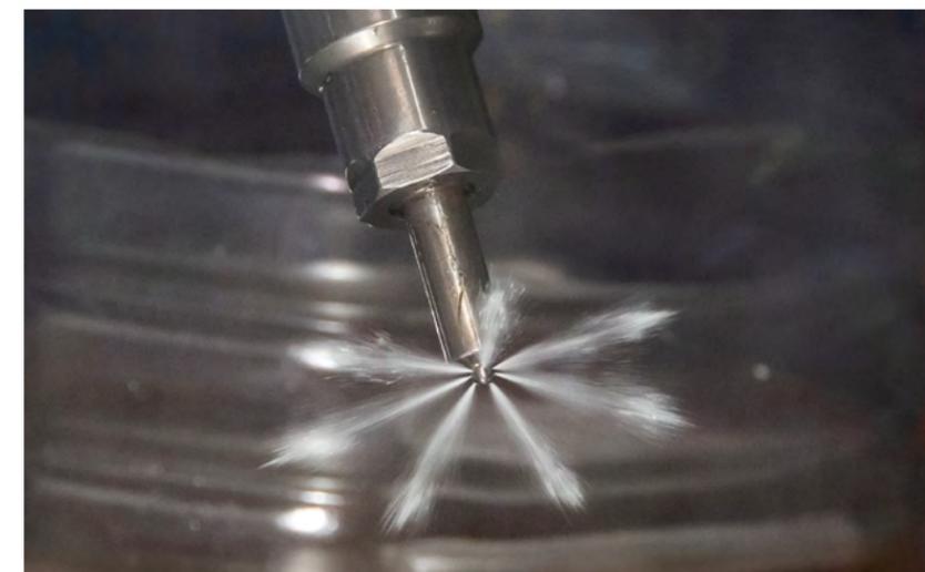
От качества распыла топлива зависит процесс его горения в цилиндрах. Отечественные распылители позволяют провести ремонт импортных форсунок с обеспечением правильного распыла топлива. При этом перевозчик не теряет в надежности и ресурсе агрегатов, выигрывая в стоимости ремонта
