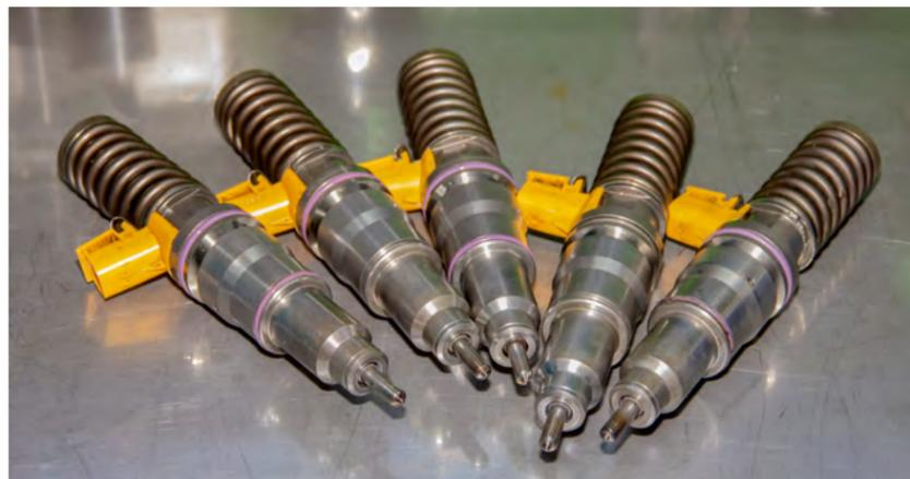
Комплект форсунок, хранящийся на складе обменного фонда агрегатов топливных систем, позволит значительно снизить простой машины в ремонте. Как показывает практика, оптимальное соотношение – один комплект агрегатов на двадцать тягачей
