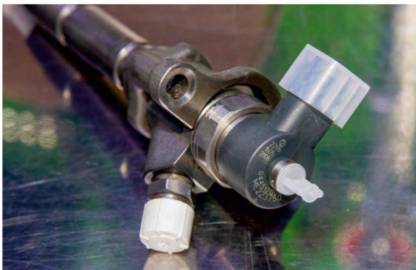
Мастерские, работающие по заводским технологиям, соблюдают их до мелочей. Например, все штуцера и разъемы отремонтированных агрегатов обязательно закрываются колпачками, которые не допускают попадания грязи внутрь форсунок и насосов
