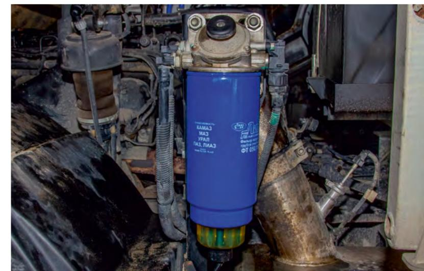
Хороший фильтр-сепаратор поможет сберечь дорогую топливную аппаратуру при заправке машины топливом с большим содержанием воды. Делайте выбор в пользу моделей с сигнализатором критического уровня воды и подогревом
