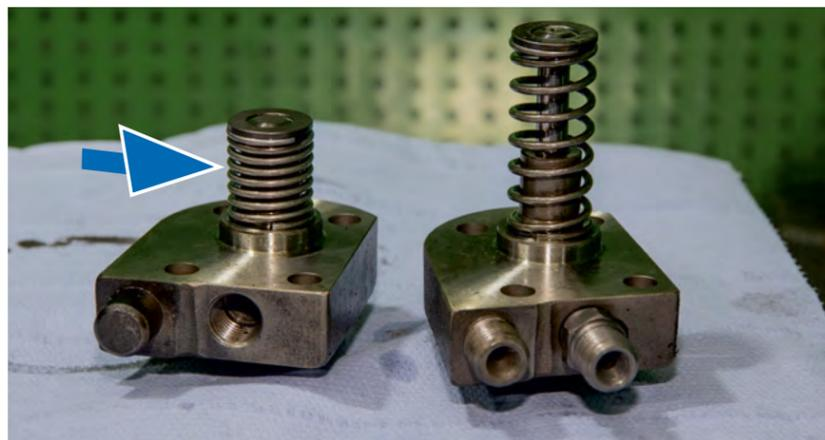
Заклинивание секций насоса может быть спровоцировано дизельным топливом, в которое при производстве добавили недостаточное количество смазывающих присадок. Заправляйте машины только на проверенных АЗС, тем самым сократятся расходы на ремонт агрегатов топливных систем
