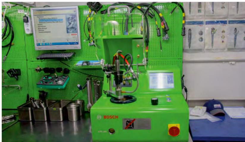
Без специальных стендов невозможно обеспечить полноценную проверку отремонтированных агрегатов топливных систем и правильное функционирование систем питания
