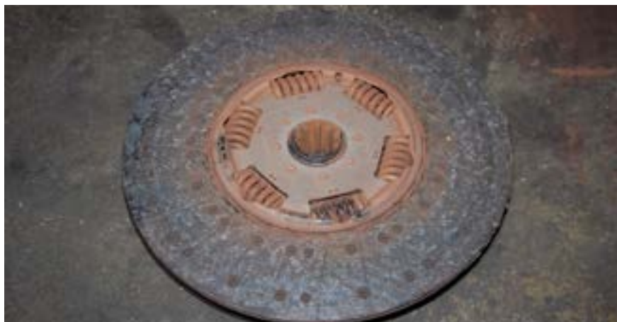
Фрикционные накладки ведомого диска сцепления изношены практически до исчезновения канавок
