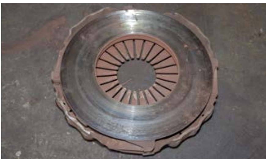
Плита ведущего диска («корзина») имеет следы сильного износа в виде колец из глубоких борозд. Присутствуют признаки перегрева в виде следов побежалости
