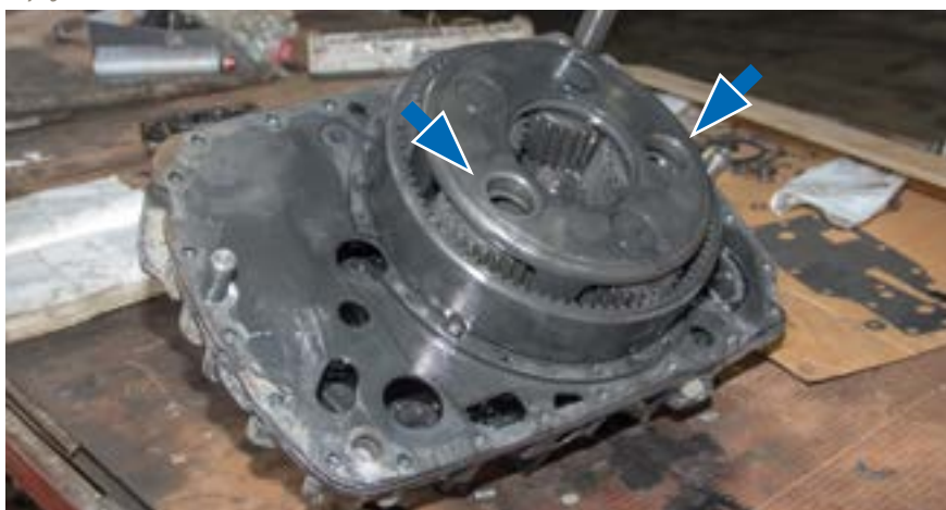
Планетарная передача КПП с двумя выпавшими осями шестерен. Замена узла, увы, не вернет КПП в строй
