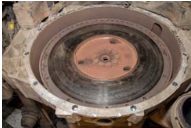
Маховик имеет следы сильного износа. Деталь требует замены
