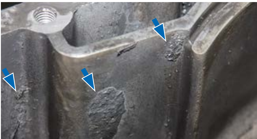
Металлическая мелкодисперсная стружка образовала конгломераты даже на корпусе КПП. Точно такая же «глина» из металлической пудры забила и сетку масляного фильтра
