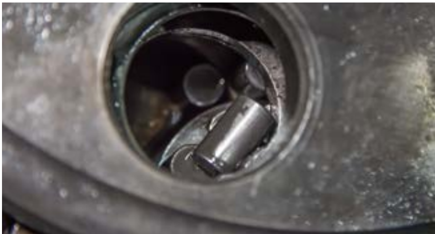
После того как вылетели оси шестерен, их перекосило, и подшипники разрушились. Элементы подшипника шестерни лежат навалом. То, что их не перемололо в труху, – удачное стечение обстоятельств
