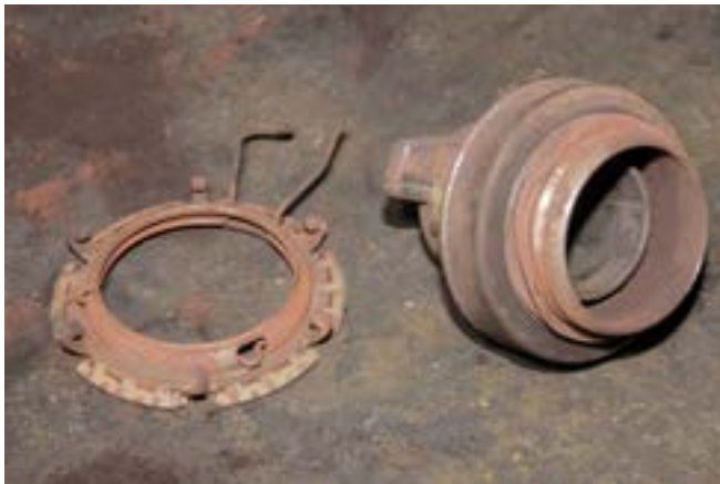
Подшипник муфты работал практически без смазки. Смазка окислилась и загустела из-за сильного нагрева
