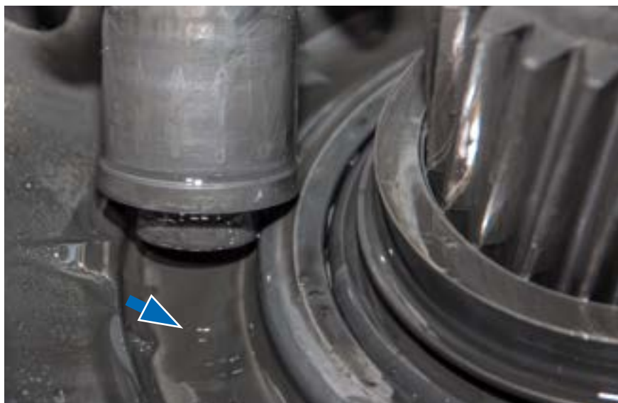
Кольцевая лунка в корпусе КПП «фрезерована» пальцем шестерни. Изначально поверхность была ровной. Представьте, сколько металлической стружки попало в масло и разнеслось по агрегату, нанося его деталям фатальные разрушения
