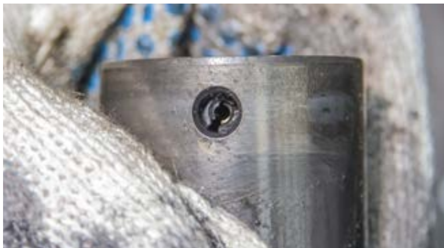
Обломанная шпонка оси шестерни – первопричина поломки КПП
