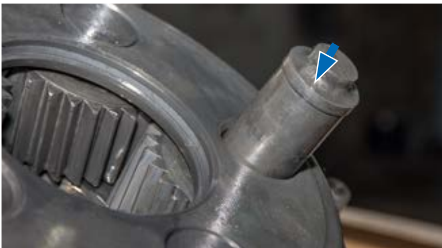
Торец выпавшего и изношенного об корпусную деталь пальца по диаметру вдвое меньше, чем в стандарте
