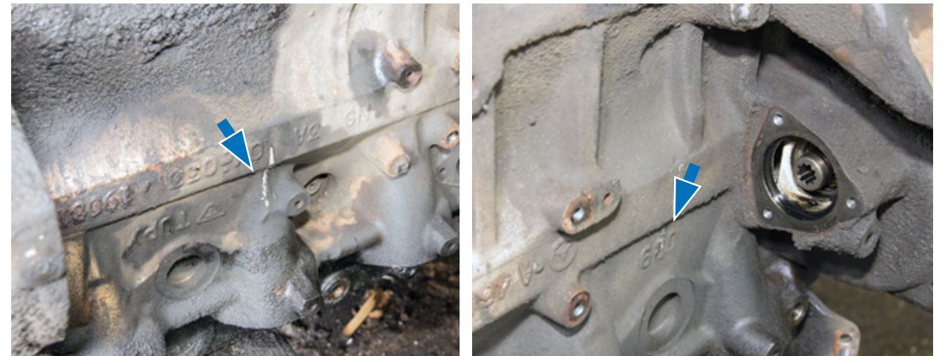
Метки на блоке цилиндров были поставлены механиками продавца. Их расположение строго соответствует местам, где имелись проблемы с толкателями. Вывод: даже мелкие подсказки не должны ускользнуть от внимания механика покупателя, который проводит диагностику силового агрегата тягача перед его приобретением
