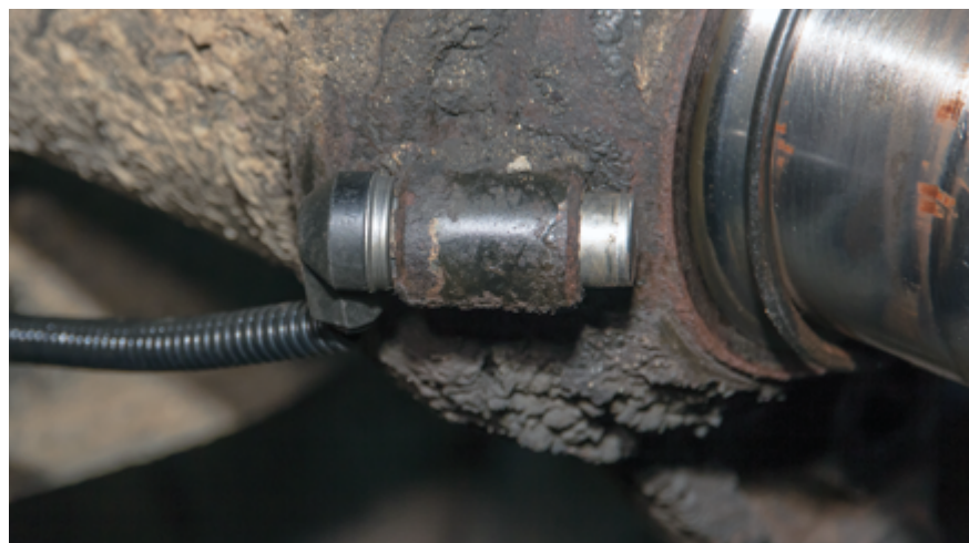
Бывшие в эксплуатации датчики антиблокировочной системы покупают очень редко, так как они в большинстве своем сильно поражены коррозией
