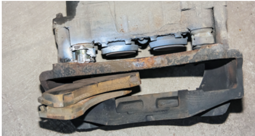
Суппорты с рваными пыльниками и следами варварской эксплуатации лучше обходить стороной
