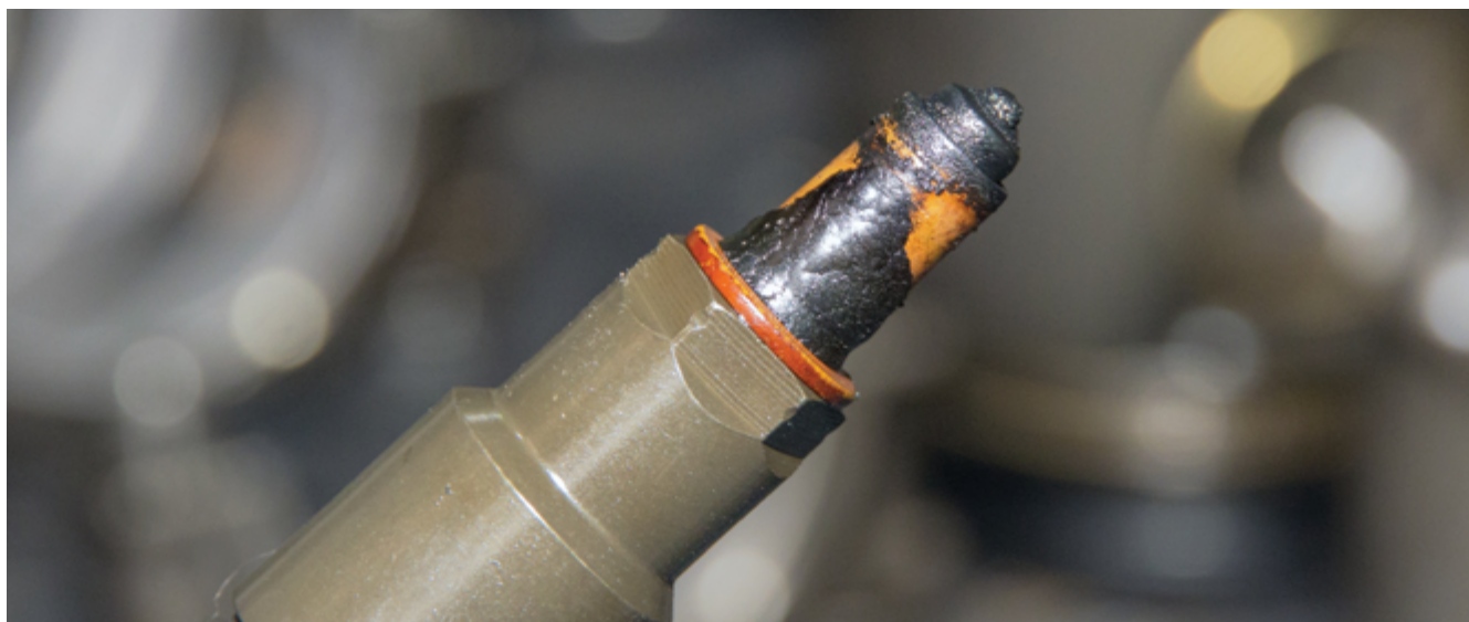
Форсунки с махровым нагаром отправляются на переборку. Стоимость работ составит примерно 36 тыс. рублей за шесть инжекторов
