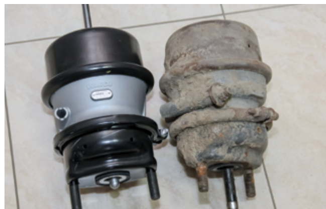
Качественная пневмокамера от альтернативного производителя всегда выгоднее, чем б/у оригинал с непонятным прошлым и неясным остаточным ресурсом
