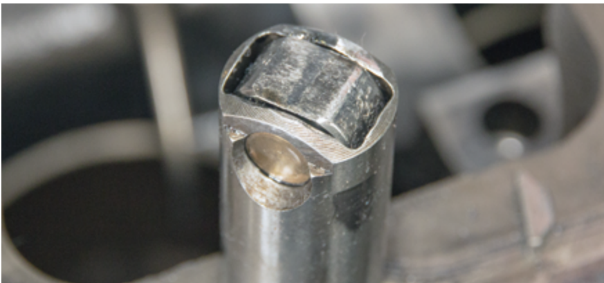
При срезании шпонки происходит проворот толкателя в посадочном колодце, ролик становится боком к кулачку распределительного вала и подобно резцу точит металл. Мотор обречен на дорогостоящий ремонт
