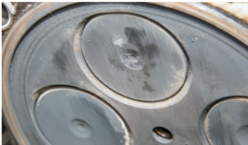
Для сравнения: так должны позиционироваться тарелки клапанов по отношению к привалочной плоскости ГБЦ, когда седла не имеют износа. При ремонте двигателя моторист, отвечающий за свою работу, непременно произведет разборку головки, выполнит дефектовку ее составляющих, как минимум притрет клапаны к седлам и заменит маслосъемные колпачки. Данная работа стоит примерно 4 тыс. рублей за одну ГБЦ
