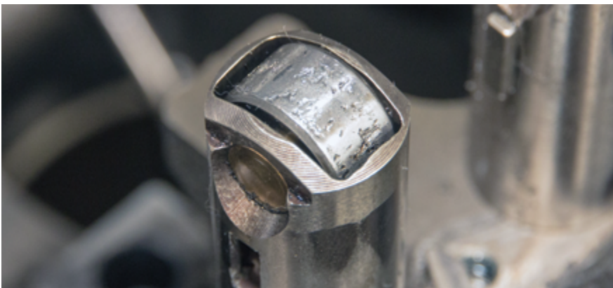
Если моторист вовремя заметит начало процесса выкрашивания металла ролика толкателя и произведет его замену, то это позволит избежать больших затрат на ремонт мотора. Однако в большинстве случаев распределительный вал спасти уже не удастся. Его шейка также будет иметь следы выкрашивания металла. Причиной данного разрушения является игнорирование регламента по регулировке привода клапанов, а также применение моторных масел несоответствующего класса качества, затягивание сроков проведения ТО
