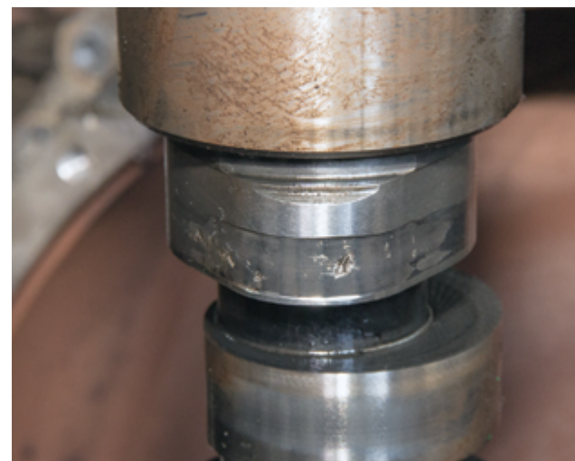
Два характерных износа кулачков распределительного вала, связанных с проворотом толкателя и заклиниванием его ролика, выкрашиванием металла при нарушении зазоров в приводе, применением масел несоответствующего класса качества, затягиванием сроков ТО. В процессе выкрашивания поверхности ролика толкателя и кулачка распределительного вала нарушается регулировка в приводе клапанов и повышается шумность работы ДВС. Это сигнал: срочно в ремонт
