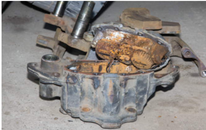
Если внутри суппорта все съедено коррозией, то покупка б/у агрегата – пустое мероприятие
