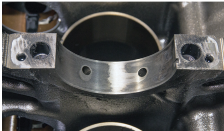
Геометрию блока цилиндров необходимо проверить по постелям коренных подшипников коленчатого вала, особенно если на них видны проплешины. Делать это нужно в специализированных мастерских, которые обладают всем необходимым измерительным оборудованием, а мастера имеют высокую квалификацию
