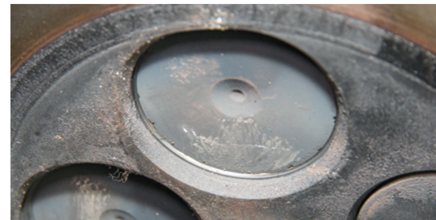
Выпускные клапаны очень сильно утоплены в головку блока по отношению к ее привалочной плоскости. Для того, чтобы диагностировать сильный износ/разрушение седел и тарелок клапанов, мерительный инструмент не требуется. Стоимость ремонта ГБЦ по самым скромным подсчетам составит не менее 8 тыс. рублей. За б/у головку на «разборках» просят от 15 тыс. рублей
