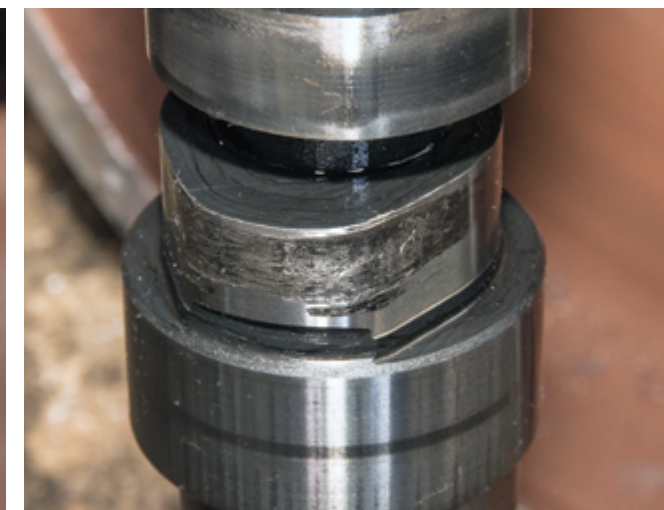
Два характерных износа кулачков распределительного вала, связанных с проворотом толкателя и заклиниванием его ролика, выкрашиванием металла при нарушении зазоров в приводе, применением масел несоответствующего класса качества, затягиванием сроков ТО. В процессе выкрашивания поверхности ролика толкателя и кулачка распределительного вала нарушается регулировка в приводе клапанов и повышается шумность работы ДВС. Это сигнал: срочно в ремонт
