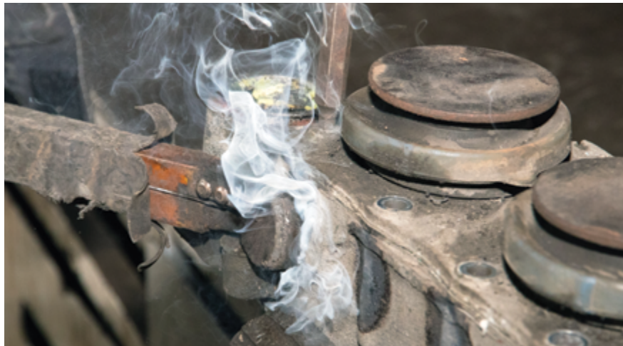
Мастера СТО рекомендуют провести профилактику б/у суппортов с применением малого ремонтного комплекта. Для этого агрегат разбирают. Часто это вызывает сложности и требует применения специального инструмента
