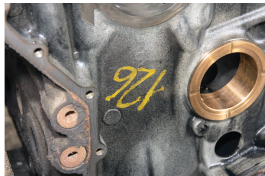
Любые не заводские отметки на блоке цилиндров могут свидетельствовать о том, что самая дорогая деталь ДВС куплена на «разборке». Никто не даст гарантий, что мотор, собранный на основе бывшего в эксплуатации блока цилиндров, будет исправно и надежно работать в течение длительного времени
