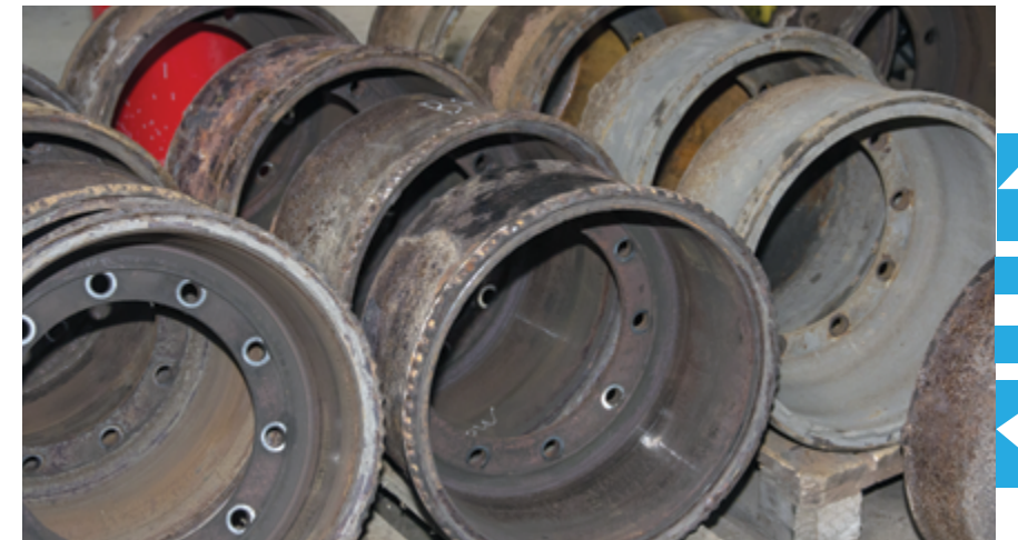
Тормозные барабаны можно покупать только при небольшом износе и отсутствии трещин. Осмотр деталей должен быть выполнен с особым пристрастием
