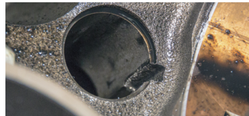
Поврежденное посадочное место толкателя в блоке цилиндров фактически приговаривает остов мотора к утилизации. Спаси ситуацию могут обходные технологии ремонта – восстановление посадочных мест и ремонтные толкатели стоимостью 35 и 10 тысяч рублей за одну «точку». Ремонт проводится на страх и риск владельца машины
