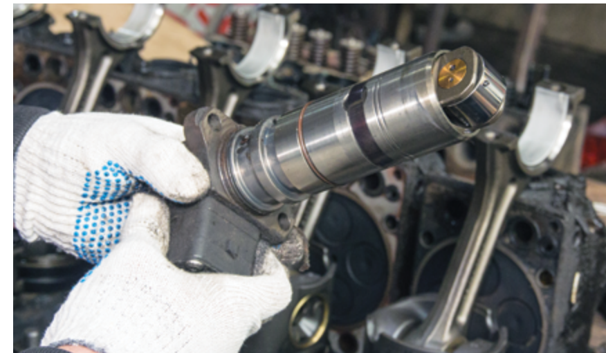
Индивидуальные топливные насосы – дорогие агрегаты. Своевременно проведенная проверка их технического состояния позволит минимизировать затраты на ремонт мотора
