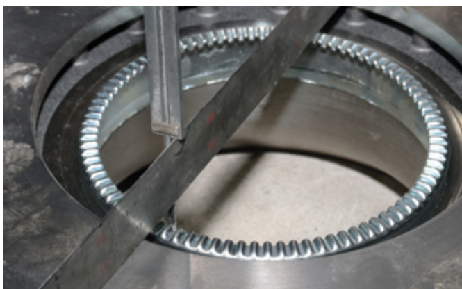
Кольца антиблокировочной системы – только новые. Максимум внимания при их установке. Посадка должна быть выполнена в строгом соответствии с заводским чертежом
