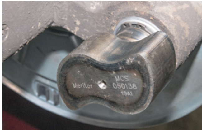
Тормозные валы лучше ставить новые. Нет денег – выбираем продукцию от альтернативных производителей. Покупать б/у валы зачастую экономически невыгодно, учитывая расходы на их доставку
