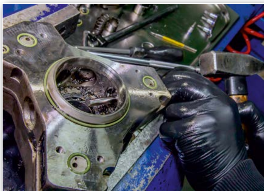
Даже у самых надежных агрегатов систем питания дизелей есть предел прочности. Этот насос восстановлению не подлежит
