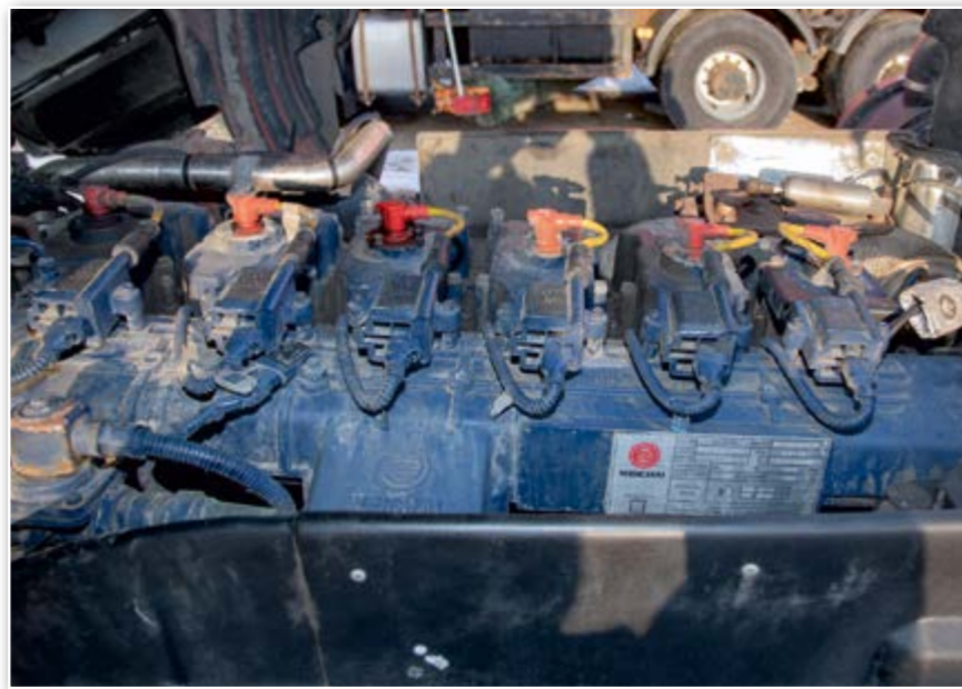
Китайские газовые двигатели Weichai стоят на седельных тягачах КАМАЗ-5490. Для их обслуживания применяются масла, изготовленные лидерами отечественного рынка смазочных материалов
