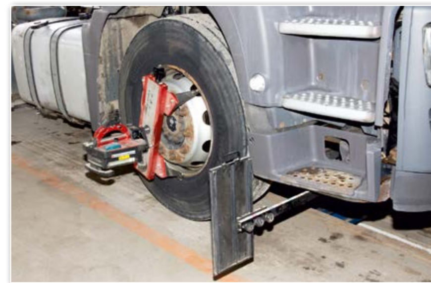
Проверка и корректировка углов установки колес позволит избежать их неравномерного износа
