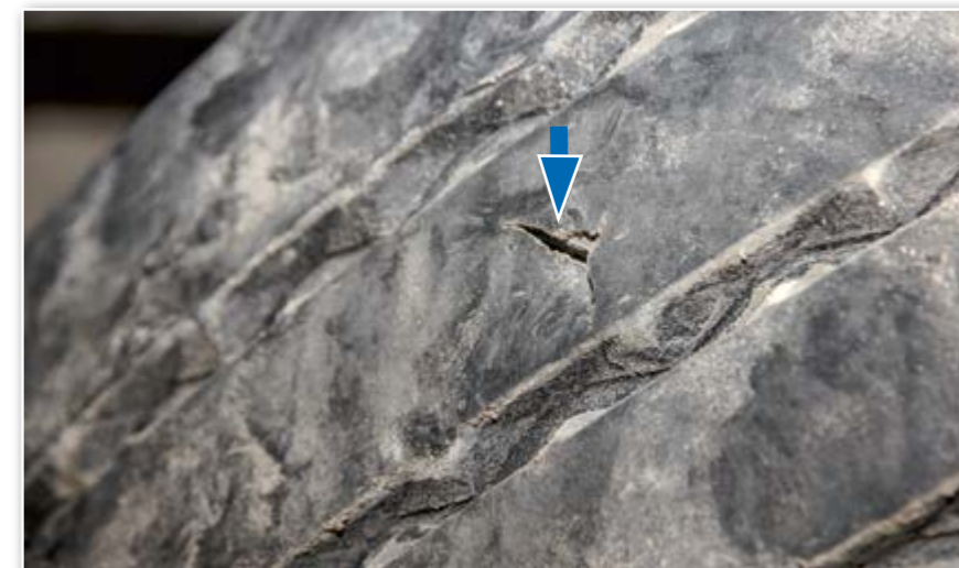
Глубокий порез протектора – повод провести его локальный ремонт
