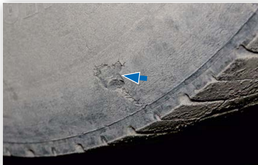
При обнаружении боковых порезов и вырывов резины шину необходимо внимательно осмотреть на предмет повреждения корда
