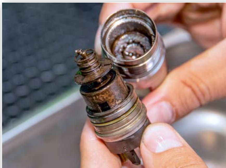
Форсунка дизеля MAN, длительное время работавшая на топливе с большим содержанием воды
